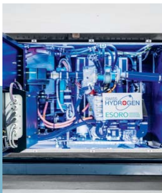
Système à pile à combustible de 100 kW de SwissHydrogen et ESORO avec stack PowerCell.
